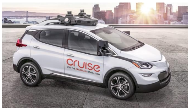
Obr. 7 Automatizované vozidlo s externou meracou sústavou
