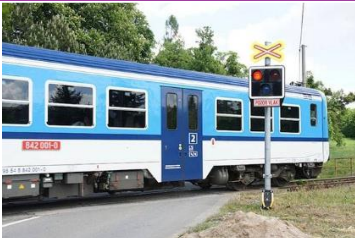
Obr. 20 Železniční přejezd se světelnou signalizací na jednokolejné trati bez závor
