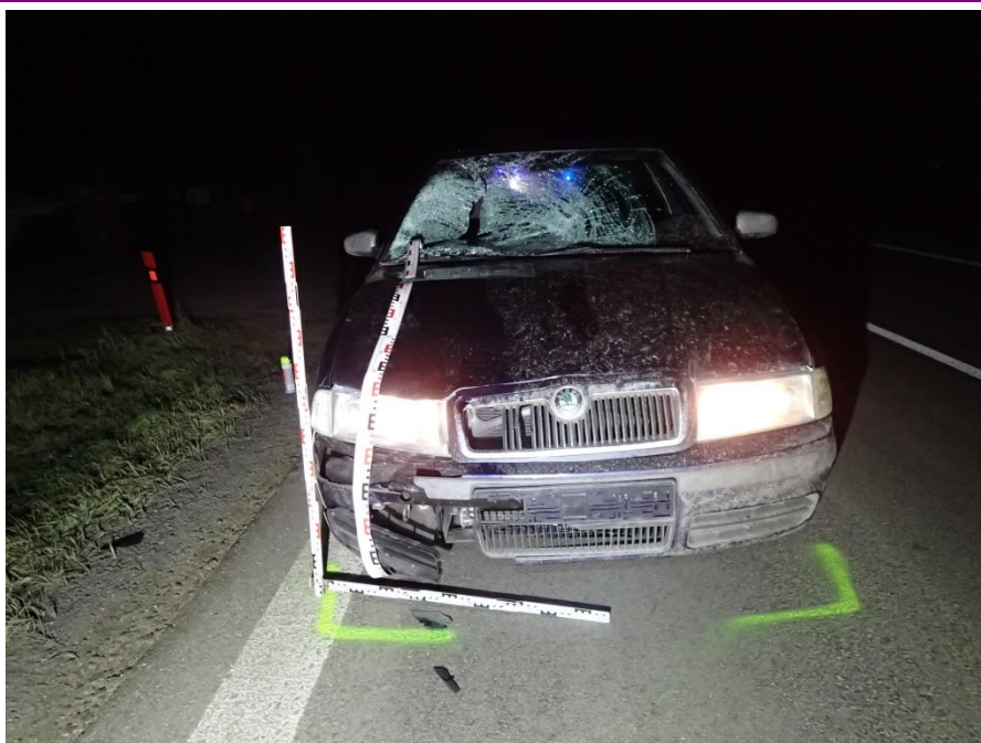
Obr. 7 Pohled na umístění deformace vozidla
