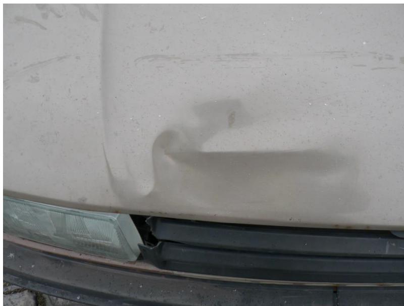
Obr. 4 Detailní pohled na deformaci vozidla
