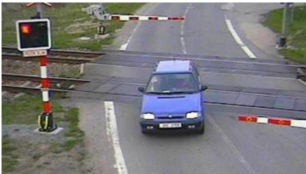
Obr. 17 Řidič odjíždí z prostoru přejezdu levou stranou vozovky, přejezd s polovičními závorami.
