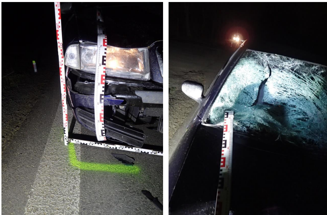
Obr. 8 Detailní pohled na deformace vozidla
