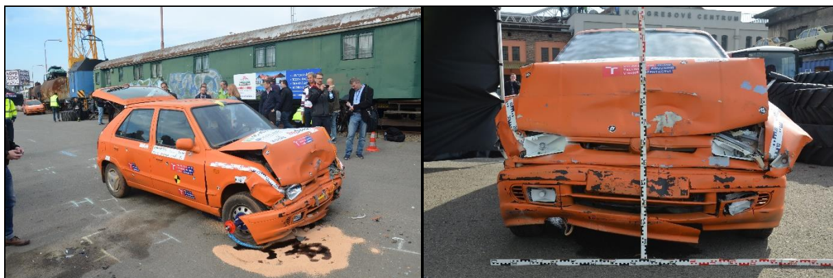
obr. 3 Vozidlo Škoda Felicia – poškození [ÚSI VUT v Brně]
