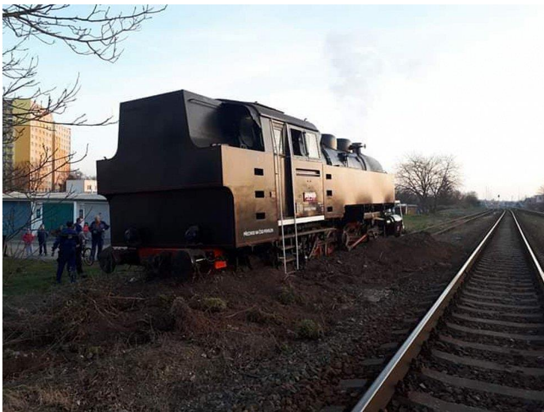
Obr. 2 Vykolejení parní lokomotivy ve Veselí nad Moravou předcházela nedovolená jízda [2]
