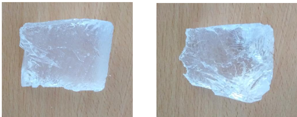
Obr. č. 4: Ukázka vzorků lukoprenu namíchané v různém poměru
