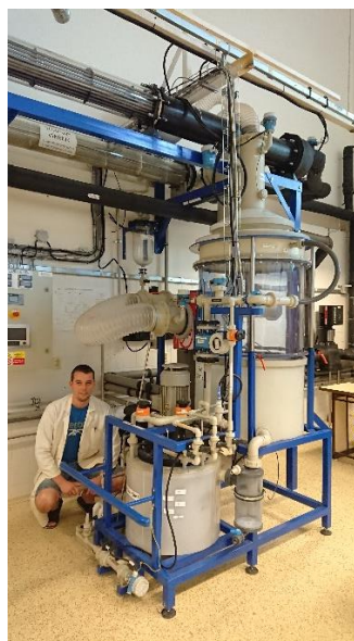
Obr. 4 – Reálná fotografie našeho laboratorního plynového scrubberu
