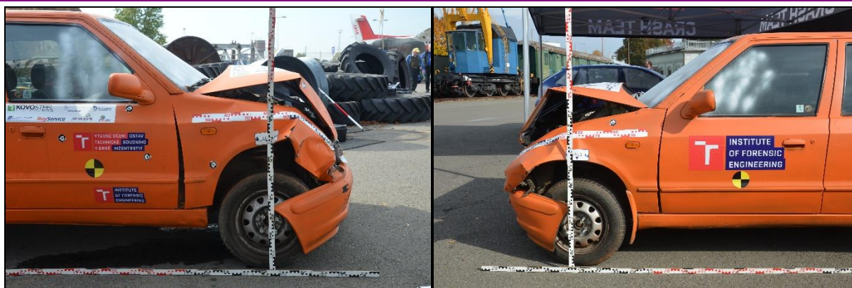
obr. 4 Vozidlo Škoda Felicia – poškození [ÚSI VUT v Brně]
