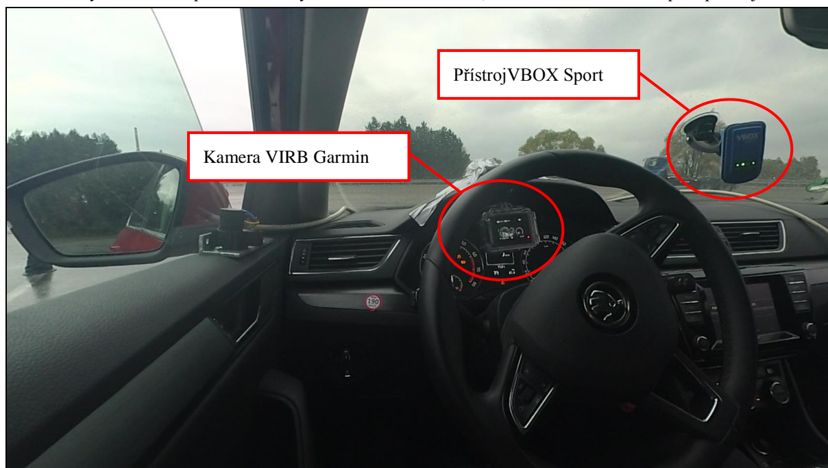
Obr. 2 – Umístění měřicích přístrojů ve vozidle
