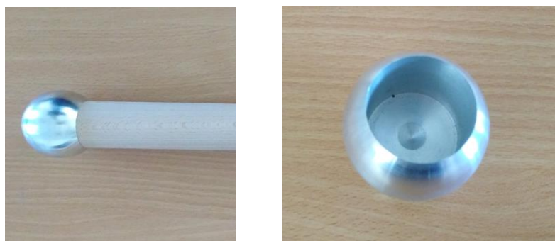
Obr. č. 5: Ukázka již vyrobených součástí figuríny pro nárazové zkoušky
