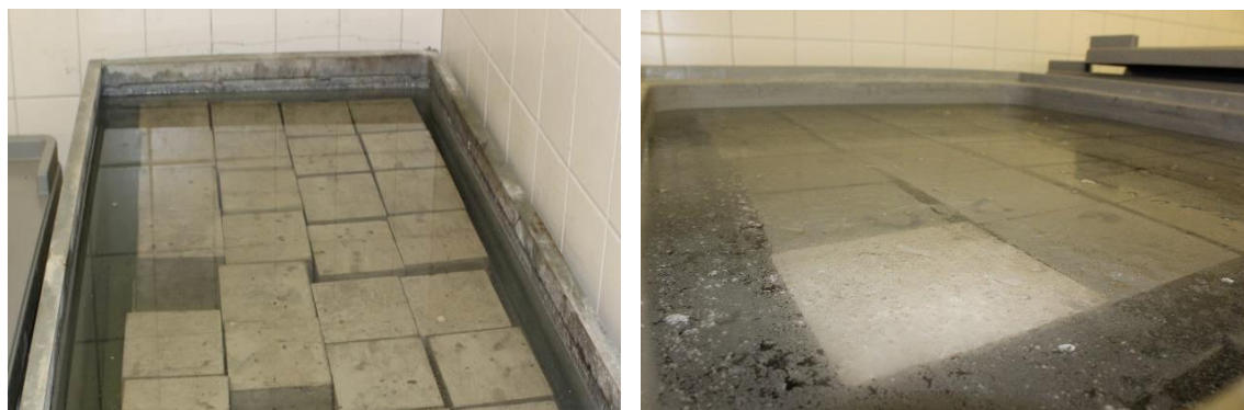
Obr. 1 Zrání betonu ve vodním uložení – standardní voda z vodovodního řádu (vlevo), použitá voda (vpravo)
