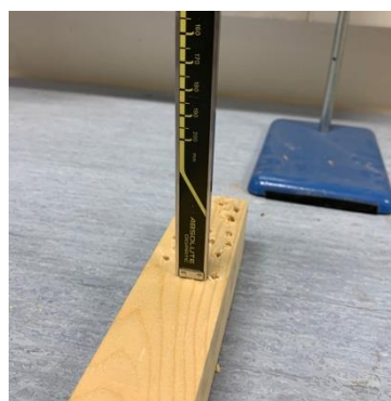
Obr. 2b Měření hloubky vrtu posuvným měřítkem
