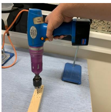
Obr. 2a Provedení vrtu do zkušební tělesa
