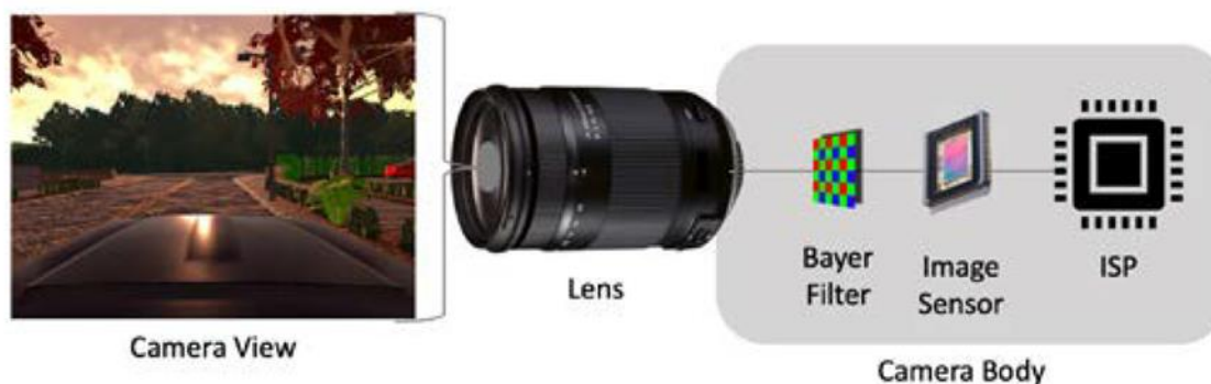
Obr. 3 Základné komponenty kamery [3]
