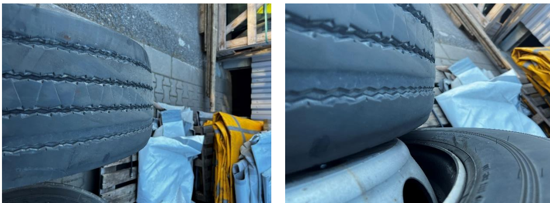
Obr. 8: Opotřebení předních pneumatik po sundání po 143 367 km provozu s mírně zvýšenou sbíhavostí
