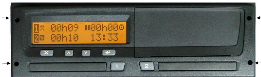
Obr. 1: Vozidlová jednotka tachografu Stoneridge, šipkami jsou znázorněny otvory pro demontáž [1]
