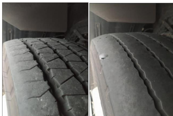
Obr. 5: Fotografie běhounu pneumatik po seřízení sbíhavosti a po ujetí 30 000 km. [2]
