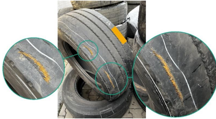
Obr. 6: Opotřebení pravé přední pneumatiky po 66 139 km. Je viditelný odhalený první nárazník.
