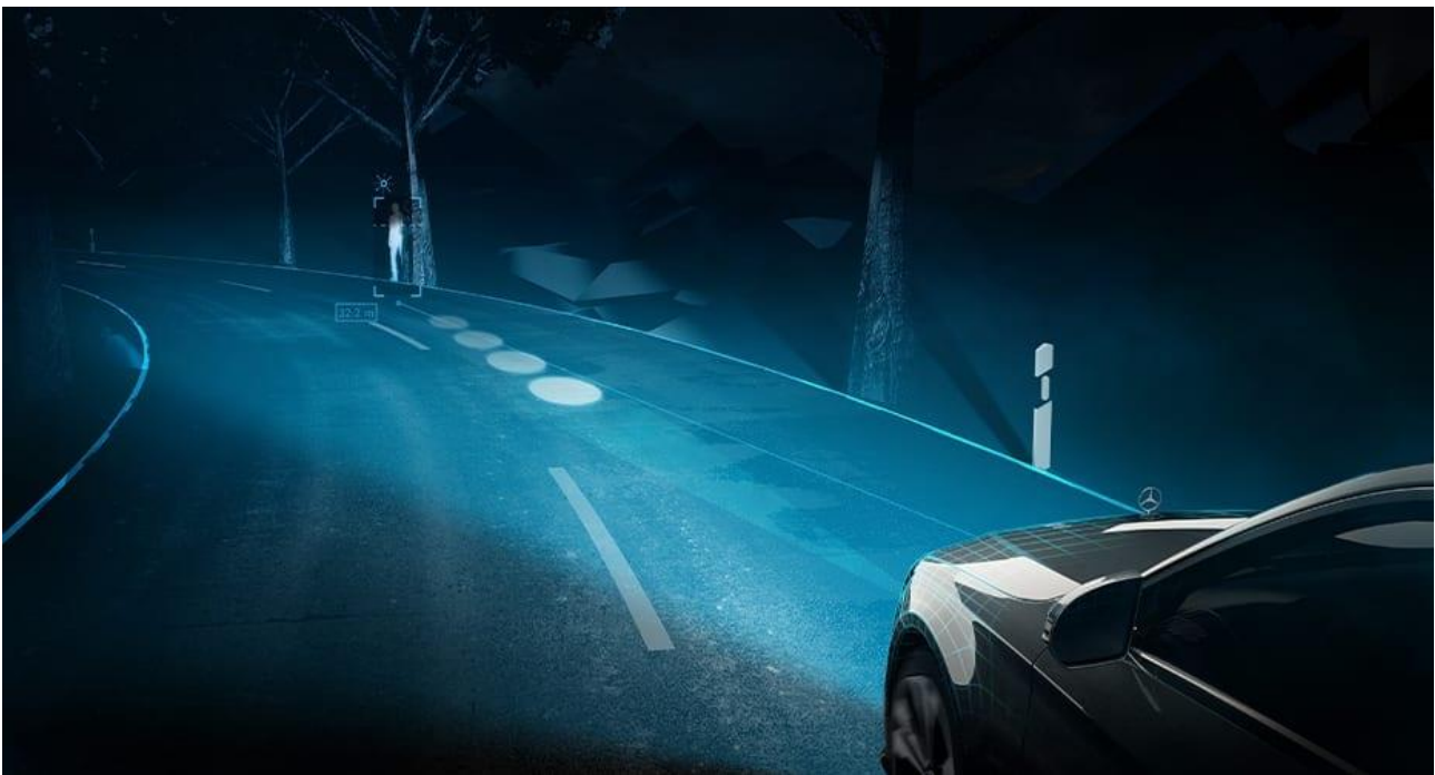
Obr. 2: Ukázka pixelových světlometů při konfrontaci s chodcem [Mercedes Benz]
